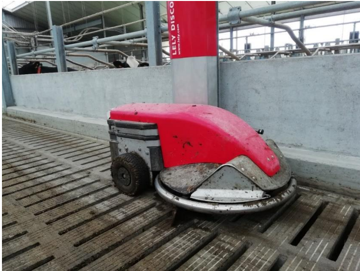
Figuur 11: De Lely mestrobot aan het oplaadstation in de ILVO melkveestal. Na het opladen gaat de robot naar het watertoevoerstation om water te tanken.
