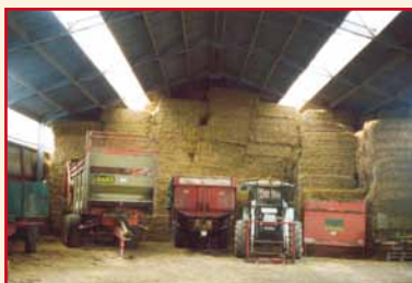
Figuur 41: Opslag van landbouwvoertuigen met verbrandingsmotor en brandbare materialen in dezelfde ruimte op korte afstand
