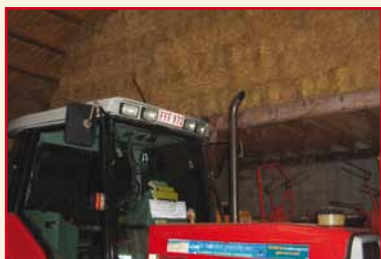
Figuur 41: Opslag van landbouwvoertuigen met verbrandingsmotor en brandbare materialen in dezelfde ruimte op korte afstand
