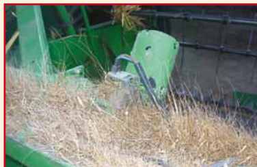
Figuur 43: Maaibek van een maaidorser zonder beschermkappen
